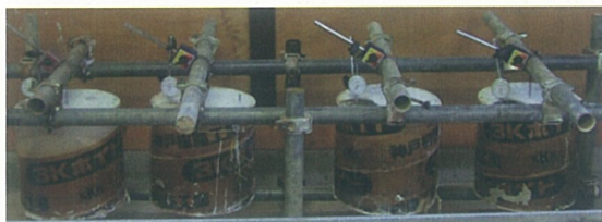
写真-2 長期耐久性比較試験状況: 荷重 32.8kgf, 定着長 15cm
