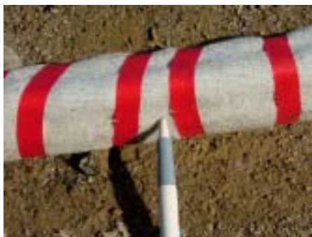
写真 3 ビニールテープの切れ目加工
