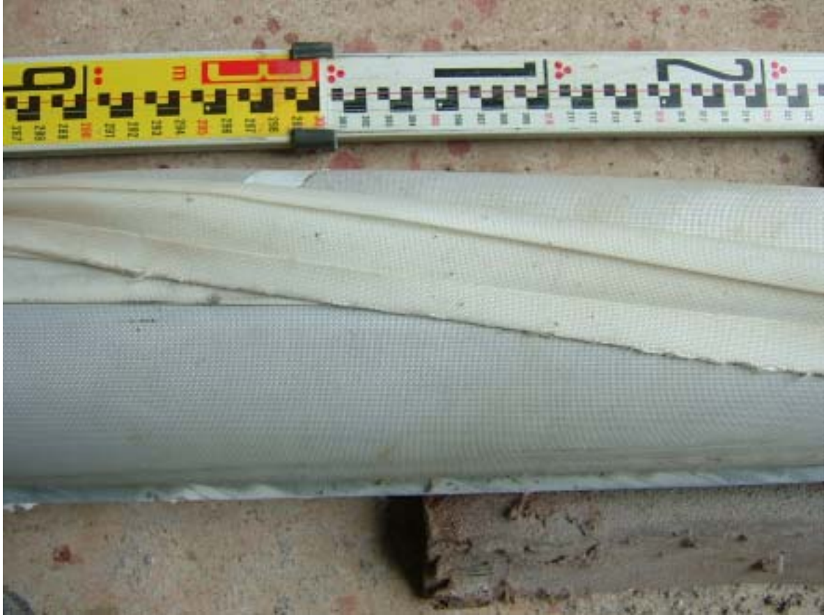
ダブルパッカーの場合 (孔径 100mm , パッカー径 130mm , グラウト圧 4.5MPa)
